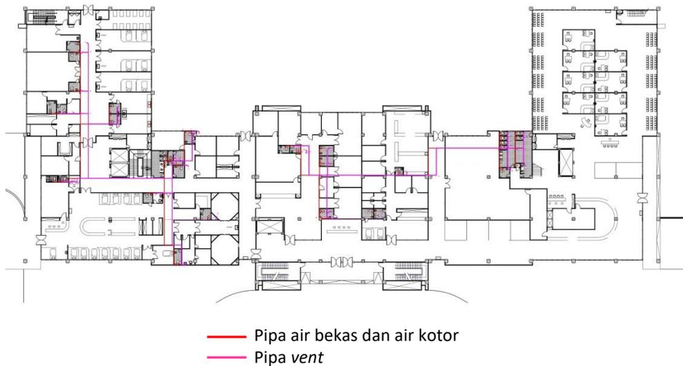
**Gambar5.** Denah Jalur Air Bekas, Air Kotor, dan Vent Lantai 1
